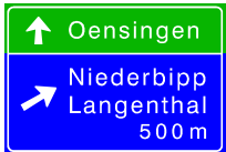
4.61 Vorwegweiser bei Anschlüssen
