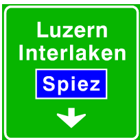
4.69 Einspurtafel über Fahrstreifen auf Autobahnen und Autostrassen
