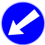
2.35 Hindernis links umfahren
